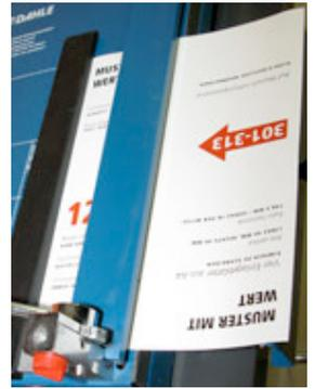
Erst vertikal schneiden, Breite ist 99 mm.
